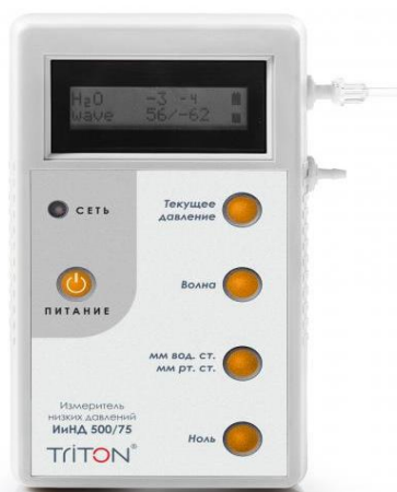
Рисунок 14 – Измеритель инвазивный портативный электронный автономный центрального венозного давления и других низких давлений в различных полостях организма человека (ИиНД - 500/75)
