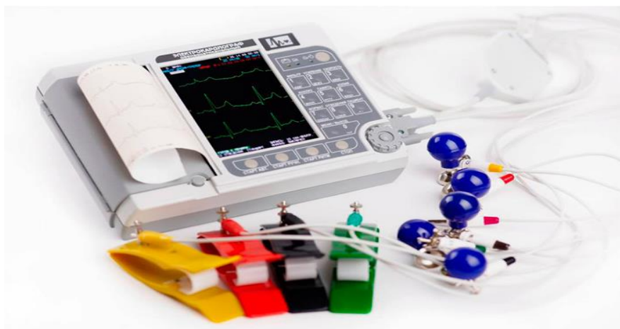
Рисунок 7 – Электрокардиограф 12-канальный с регистрацией ЭКГ в ручном и автомат. режимах мини ЭК 12 Т01-"Р-Д" (141 мм)
